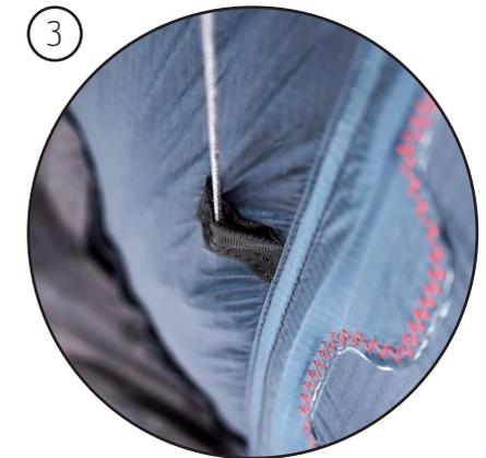
Der zweistufige Beschleuniger ist über eine kugelgelagerte Rolle leicht zu betätigen.
