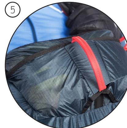
Das Front Rettungssystem befindet sich auf der Oberseite des Beinsacks und fungiert durch seine gute Lage gleichzeitig als Cockpit.
