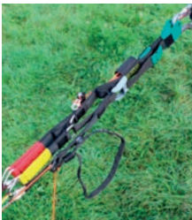
Einhängung Bergflug (Trimmer im Hauptkarabiner fixiert)
