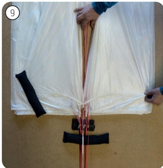
10. Das überflüssige Tuch kann wie im Bild einfach im inneren des Kanals nach oben geschoben werden. Grund dafür ist, Verbrennungen des Tuchs bei einem Öffnungsschlag zu vermeiden.
