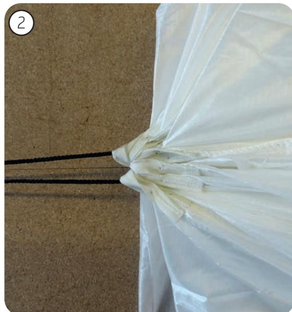
2. Fixiere anschließend die Packschlaufen und bringe den Hauptgurt sowie die daran eingeschlaufenen Fangleinen unter Spannung.
