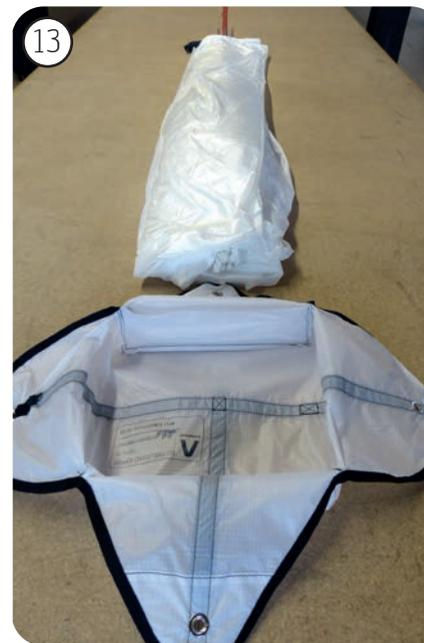
13. Falte das Rettungsgerät nun mit einem „doppelten S-Schlag“ bzw. verwende den „einfachen S-Schlag“ für die Größen 180 & 225 und platziere den Rettungsgerätecontainer mit Leinenfach in Richtung Basis/ Hauptgurt.
