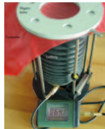
>> Der JDC Porosimeter misst die Luftdurchlässigkeit des eingespannten Tuches.
