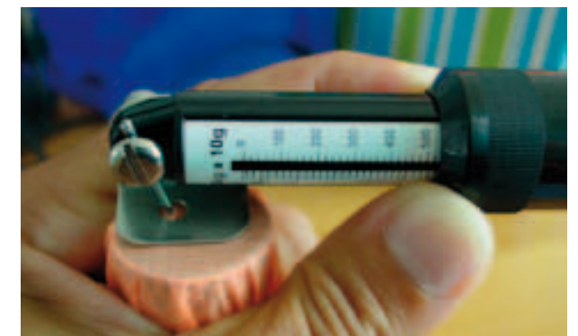
>> Bettsometer zur Bestimmung der Reißfestigkeit.
