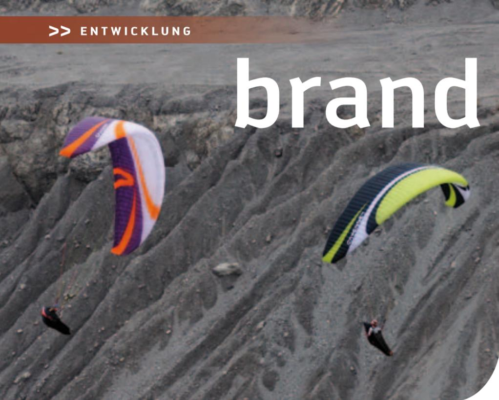
Leistungspotential legen. Bei der Entwicklung des CAYENNE4 haben wir das Feedback unserer Team-piloten und vieler Streckenflieger zum CAYENNE3 umgesetzt. Die Steuerdrücke wurden erheblich reduziert und das gesamte Handling abgerundet. Für die markant reduzierten Steuerdrücke zeichnen sich unter anderem eingesetzte Miniribs verantwortlich. Nebenbei verringern diese auch etwaige, unliebsame, weil Leistung mindernde, Schwingungen des Flügels in Längsrichtung.
