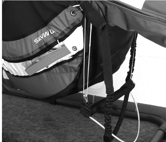
Dadurch wird ausgeschlossen, dass das Rettungsgerät durch Beinstrecker oder Beschleuniger hindurchfallen kann.
