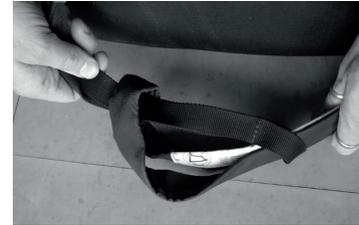
1. Einschlaufen des Verbindungsgurtes: dazu wird die Verbindungsleine durch den Tragegurt des Rettungssystems gesteckt. Danach wird das Rettungssystem durch die Schlaufe gesteckt, welche dann zugezogen wird und straff um den Tragegurt liegen muss.
