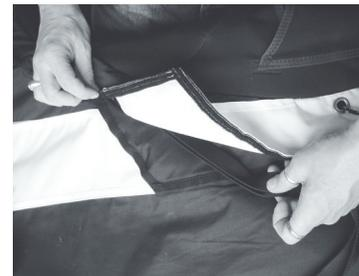
3. Verbindungsgurt nun im dafür vorgesehen Kanal im Gurtzeug verlegen und diesen wieder verschließen.
