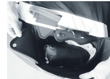
4. Auslösegriff an der Befestigungsschlaufe des Innencontainers einschlaufen und in den Außencontainer wie abgebildet einlegen. Dabei ist darauf zu achten, dass die Verbindung zwischen Befestigungsschlaufe und Auslösegriff nach oben (zum Protektor) zu liegen kommt. Anderenfalls besteht beim auslösen die Gefahr eines Verkantens.
