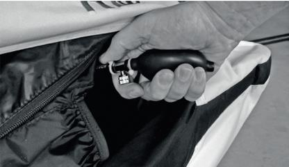
Um eine möglichst günstige Aerodynamik zu gewährleisten, muss gerade auch das Heck des Gurtzeuges eine optimale Form bilden. Hierfür haben wir das RANGE mit einer aufzupumpenden Airtube mit zugehörigem Blasebalg versehen. Dieser befindet sich im oberen Ende der Rückentasche.
