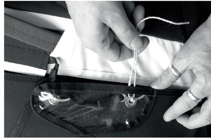
5. Die Packschnüre in die Loops einführen. Nun zuerst auf der einen Seite die Packschnur nacheinander durch die Ösen der übereinanderliegenden Klappen ziehen. Splint durch den Loop stecken.
