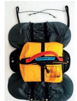
3. Führe die V-Leine links und rechts der Deckelklappe (mit Klettverschluss auf der Oberseite) vorbei und achte darauf, dass ca. 10-15cm vom Ende der V-Leine aus dem Frontrettungscontainer hinausragen.
