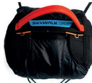
8. Nun kannst Du den Frontcontainer noch optisch in eine gute Form bringen, indem Du überstehendes Tuch sauber im Frontcontainer verstaust. Der Frontcontainer ist nun fertig gepackt und kann montiert werden.
