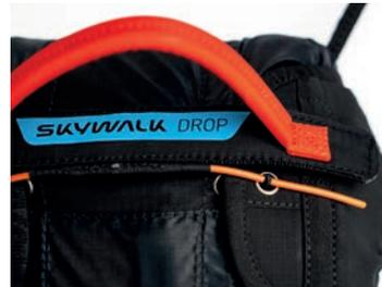
7. Verstaue die Splinte sowie die Enden des Rettungsgriffs in den Öffnungen links und rechts neben den Ösen und sichere den Rettungsgriff mit dem Klettverschluss.
