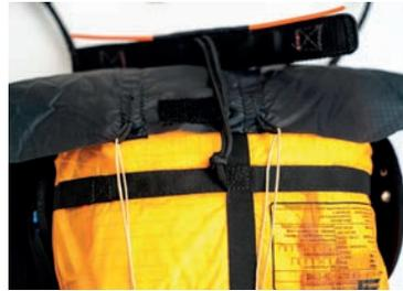
5. Schließe zuerst die rechte Klappe mit der Nummerierung 1-3 und fixiere den Loop mit dem Splint des Rettungsgriffes. Achte dabei darauf, dass der Rettungsgriff richtig herum montiert wird, da ansonsten das Verbindungsgurtband den Klettverschluss verdeckt. Entferne die Montageleine auf dieser Seite.
