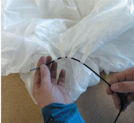
2. Fixiere anschließend die Packschlaufen und bringe den Hauptgurt sowie die daran eingeschlauten Fangleinen unter Spannung.
