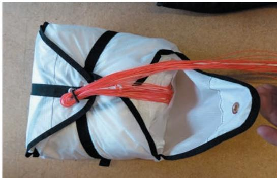
16. Nun werden vom Hauptgurt beginnend die Leinenbündel in Form von Achtern geschlaucht. Verwende zur Fixierung der Leinenbündel Leinengummis auf Silikonbasis. Dabei ist darauf zu achten, dass sich kein Leinenknoten im Leinenloop befindet. Die geeigneten Packgummis erhältst Du bei Deinem Händler oder bei skywalk direkt. Achte dabei darauf, zum ersten Achter ca. 30cm frei zu lassen. Diese Länge wird für den finalen Leinenloop benötigt.
