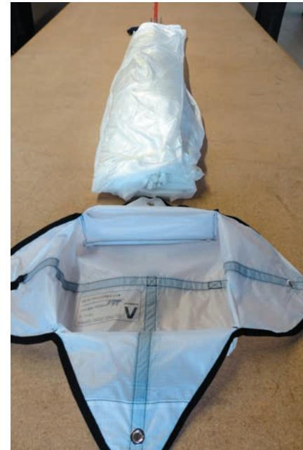
13. Falte das Rettungsgerät nun mit dem Deiner Größe entsprechenden „S-Schlag“ und platziere den Rettungsgerätecontainer so, dass die Rettungsklappe mit dem Gummiloop von der Basis aus gesehen zur Seite schaut.
