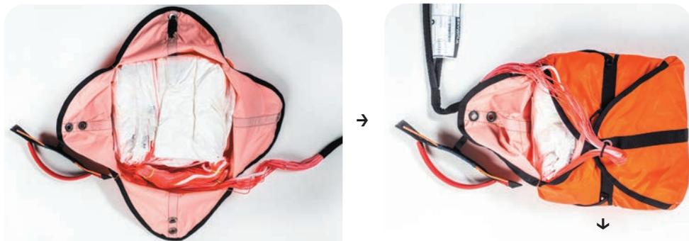
3. Fixez la boucle élastique avec le faisceau de lignes et veillez à ce que la boucle ait une longueur maximale de 3 cm. 3 cm de long.
