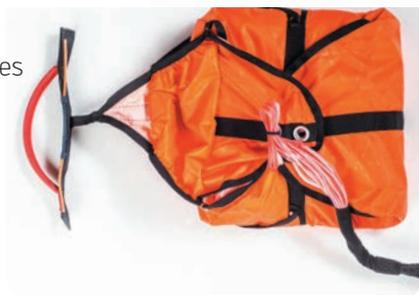
4. Vous pouvez maintenant connecter les drisses secours Y de la BREEZE avec la longe de votre parachute de secours. Pour connecter le parachute de secours aux drisses secours Y, vous devez utiliser un maillon à vis d'une résistance d'au moins 2400 daN. Les drisses doivent être connectées des deux côtés du maillon à vis et doivent être fixées avec des élastiques (image 1).
