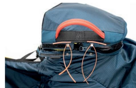
zwei kurze Hilfsleinen (aufgrund der geringen Reibung empfehlen wir hierfür unummantelte, nicht allzu dünne Gleitschirmleinen oder Rigid Foils), die Du in die beiden Schlaufen am Frontcontainer einfädelst. Ziehe die beiden Schlaufen mit Hilfe der Hilfsleinen durch die beiden Ösen.
