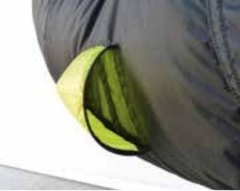
Das RANGE AIR ist ein Gurtzeug mit eingebautem Staudruck-Protector. Der Staudruck-Protector ist unterteilt in Haupt- und Rückenkommer, so kann im Falle eines harten Aufpralls nicht die gesamte Luft auf einmal entweichen. Das RANGE AIR wurde entwickelt um die Aufprallenergie so weit wie möglich zu absorbieren und den Piloten im Falle eines Unfalls bestmöglich zu schützen. Das Verletzungsrisiko kann aber nicht komplett eliminiert werden.
