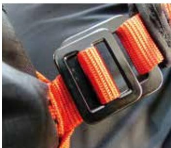
**Um die Verbindung der Rettung zum Gurtzeug herzustellen, ist vor jedem Start das „Get Up“ System mit den beiden „frame buckle“ herzustellen, sowie die Enden der V-Verbindungsleine in den jeweiligen Hauptkarabiner einzuhängen.**
