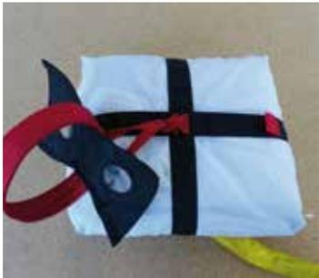
Bei der Installation des Rettungsgerätes in den RANGE AIR Frontcontainer muss besonders darauf geachtet werden, dass die Einschlaufung des Auslösegriffs am Innencontainer am mittleren Loop erfolgt und nicht seitlich.
