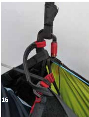
Für eine einfach zu erreichende Position des Rettungsriffs sowie die Auflösbarkeit bei einem Leinentwist, ist das Beinsackverschlussystem durch die beiden Loops am Frontcontainer der jeweiligen Seite zu führen.
