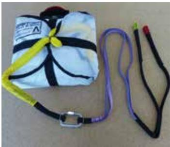
Zusätzlich sollten die Verbindungselemente auf beiden Seiten des Schraubschäkels mit Gummiringen fixiert werden. Gurtband/Gurtbandverbindungen werden nicht empfohlen, da bei asymmetrischer Fixierung das Gurtband rutscht und im Falle einer Rettungsöffnung wegen der entstehenden hohen Reibungswärme reißen kann.
