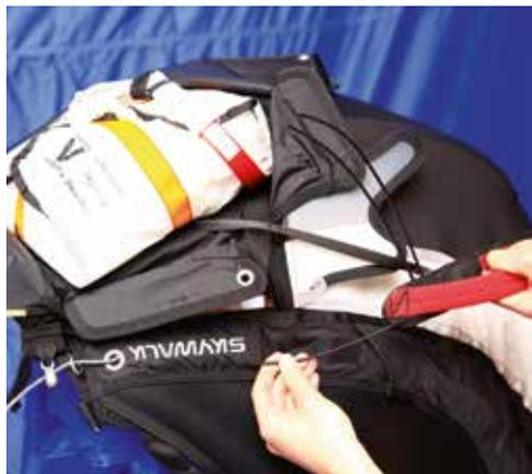
**1** Das Rettungsgerät wird so in den Außencontainer gelegt, dass die Verbindungsleine und der Rettungsriff des Rettungsgerätes beide auf die rechte Seite des Gurtzeuges führen. Somit ist der Weg der Verbindungsleine und des Rettungsriffs zum Gurtzeug direkt und wird nicht behindert.
