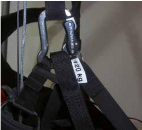
Vor dem Einhängen des Hauptaufhängungsgurtes wird der seitliche Gurt der Rückenabstützung durch die kleine Schlaufe am Hauptaufhängungsgurt geführt (sie verhindert das Hochrutschen im Karabiner). Dann wird der Hauptaufhängungsgurt in den Karabiner eingeführt. Zuletzt wird die Vorderkantenaufhängung ebenfalls mit in den Karabiner eingehängt.
