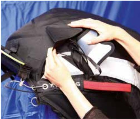
**7** Nachdem beide Splinte eingefädelt sind, müssen die beiden kleinen Abdeckblätter noch an ihre jeweiligen Stellen eingesteckt werden. Nun ist das Rettungsgerät mit dem Rettungsgriff vollständig in das Gurtzeug eingebaut.
