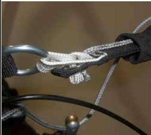
**4** Die kürzere, weiße Schlaufe wird nun durch die längere, weiße Schlaufe von oben nach unten durchgefädelt und anschließend durch die Öse des Beinstreckers geführt. Dabei kann wieder eine Hilfsleine die Montage erleichtern.
