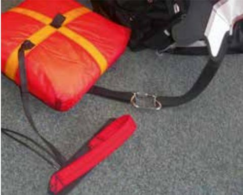
Das CULT3 kann mit den meisten auf dem Markt erhältlichen Rettungsgeräten kombiniert werden. Die Erstinstallation des Rettungsgerätes muss von einem zugelassenen Kompatibilitätsprüfer vorgenommen werden. Dieser überprüft die Auslösbarkeit des Rettungsgerätes und bescheinigt die Kompatibilität auf dem Prüf- und Packnachweis des Rettungsgerätes.
