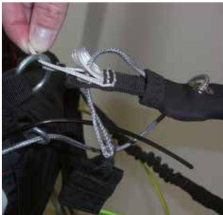
**3** Ist die graue Leine des trennbaren Beschleunigers wie beschrieben montiert, wird die längere, weiße Schlaufe des Beinstreckers durch den Ring an der Gurtzugvorderkante gezogen.
