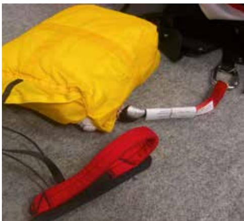
Der fest vernähte Rettungsgriff und der Innencontainer bilden eine Einheit. Diese Einheit wird analog der Beschreibung oben in den Außencontainer gepackt.
