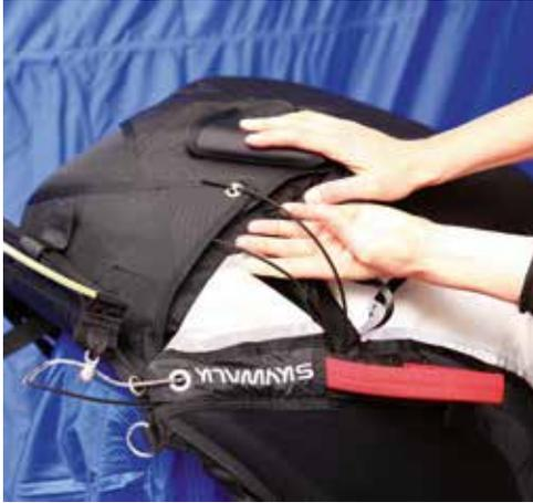
**6** Die zweite noch übrige Hilfsleine wird nun durch die letzte Öse des vorderen Blattes gefädelt und der rechte Splint des Rettungsgriffs durch die Schlaufe gesteckt. Anschließend wird auch hier die Hilfsleine vorsichtig und langsam aus der Schlaufe gezogen. Nun sind beide Splinte eingefädelt und der Außencontainer mittels beider Splinte gesichert und verschlossen.
