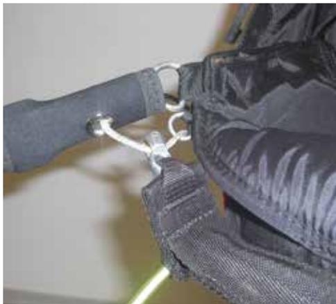
Die Funktion der Kupplung und des Rettungsgeräteeinbaus ist durch eine Probeauslösung zu verifizieren.
