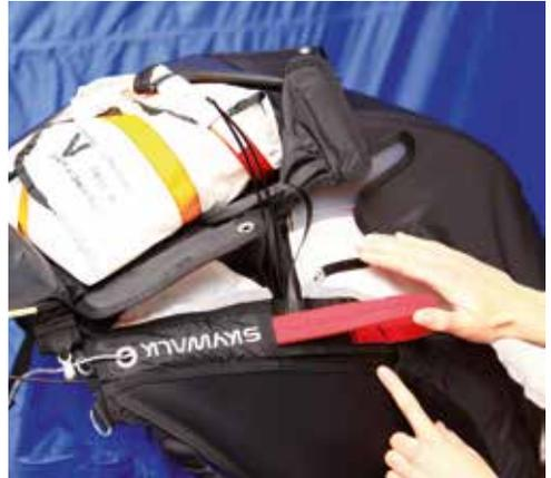
Der Rettungsgriff wird bis zu seiner Endposition in die vordere Führungstasche und dann auch in die hintere Führungstasche eingesteckt. Der Rettungsgriff ist nun am Gurtzeug befestigt.
