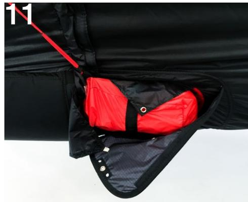
Überprüfe anschließend die Auslösbarkeit des Rettungsgeräts in deinem RANGE X-ALPS in einer Kompatibilitätsprüfung. **Diese ist vom Piloten selbst durchzuführen.**
