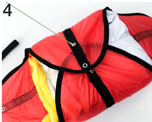
Führe wie in Bild 4 zu sehen den Gummi durch die Ösen. Je nach Volumen der Rettung kann die Größe des Innencontainers angepasst werden.
