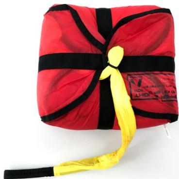
Anschließend vom originalen Innencontainer separieren. Ggf. das Herstellerhandbuch deines Rettungsgeräts zur Hand nehmen.
